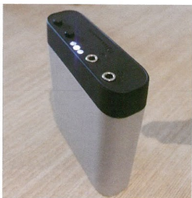
機前的顯示燈，能顯示例如增益及電源等狀態。
